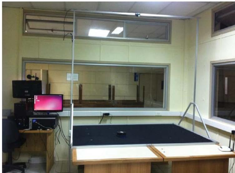
Figura 1-1 Plataforma con sistema de localización por cámara en laboratorio PUCV [5]
