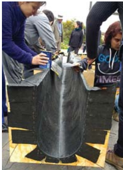
Moldaje para vigas
