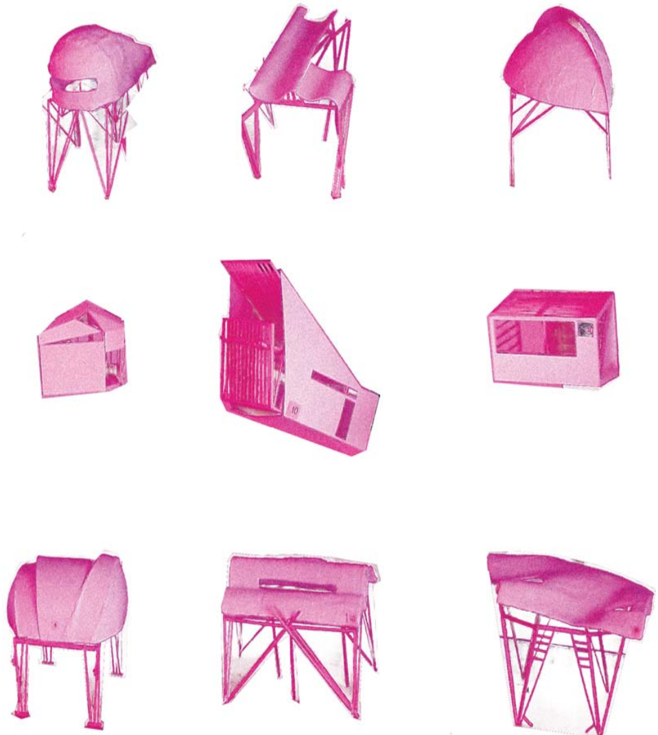
Modelos de estudio de estructura de techumbre y balloon frame. Fuente: Elaboración propia
