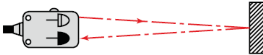
Figura 6.4: Imagen de sensor óptico reflexivo con emisor y receptor juntos Fuente: Recuperado de (Keyence, 2019)
