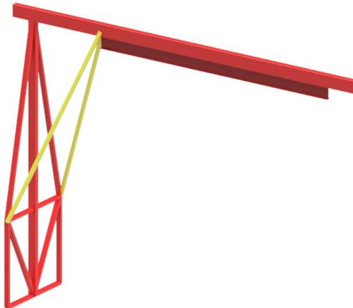
*Figura 6.1: recomendación de barra diagonal doble. Fuente: elaboración propia.*
