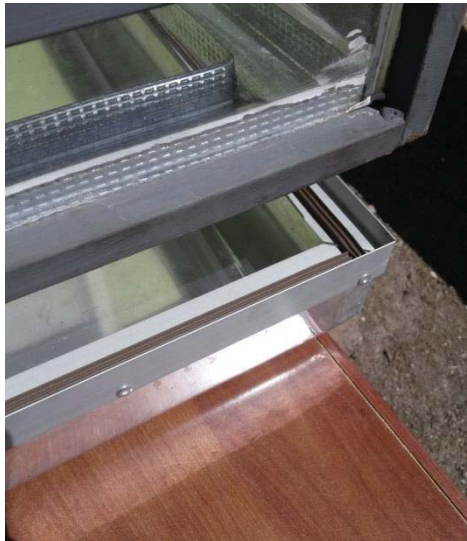
Figura 3.12. Canaletas de recolección de destilado.
