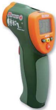
Figura 4.2. Termómetro Infrarrojo, para medir temperatura de la cubierta (Condensador).
