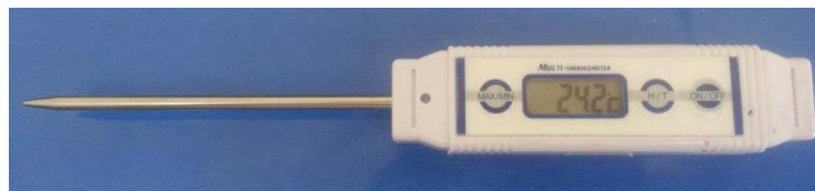
Figura 4.1. Termómetro de punta, para medir temperatura del RIL.
