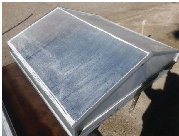
Figura 3.10. Formación de gotas producto de la condensación del equipo.
