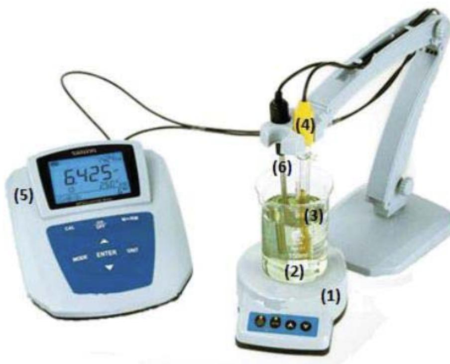
Figura 8. Equipo experimental para las pruebas de remoción y elución. (1) Agitador magnético, (2) Barra magnética, (3) Vaso precipitado 500 mL, (4) Electrodo, (5) pH-metro, (6) Termocupla.
