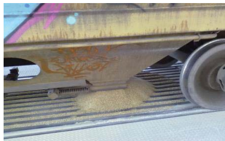
Figura N°8. Descarga de los vagones cargados de malta, hacia las bodegas.
