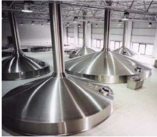
Figura N°12. Imagen exterior filtro Lauter.
