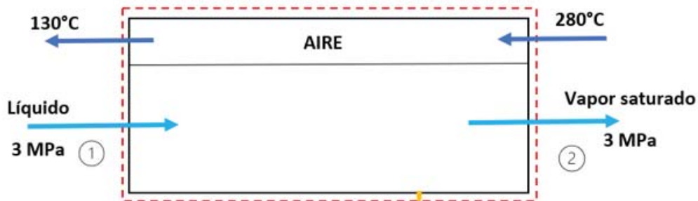
Figura 5-3 Diagrama de flujo caldera.
