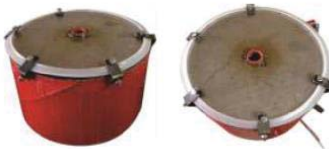
Ilustración 18: Horno de resistencia eléctrica para compactación en caliente. [13]
