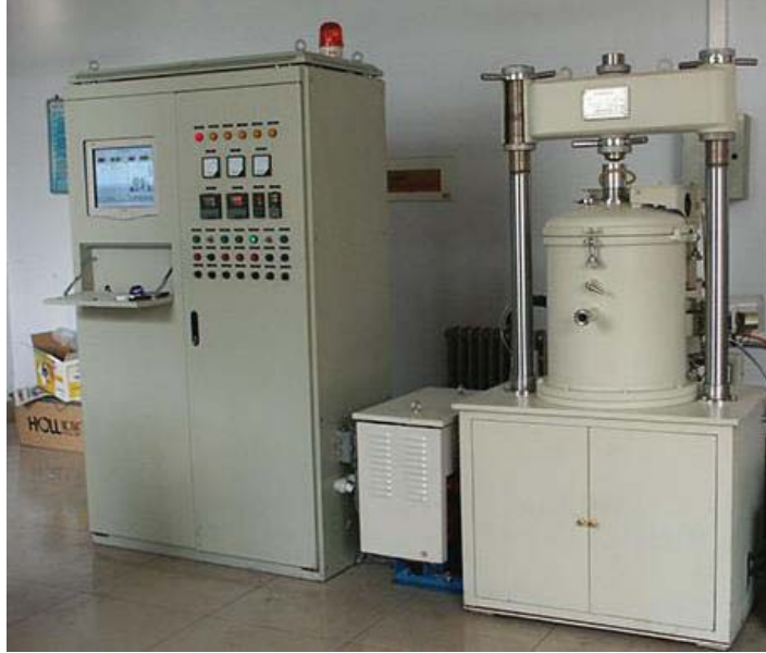
Ilustración 14: Horno de Vacío con Prensa en caliente [10]
