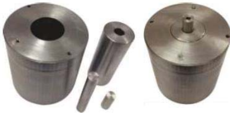
Ilustración 24: Ilustración 18: Matriz de compactación de acero H-13 [13]
