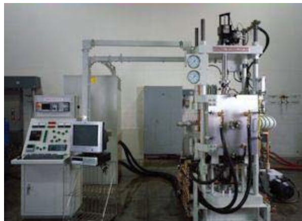
Ilustración 15: Prensa en caliente con vacío integrado [11]
