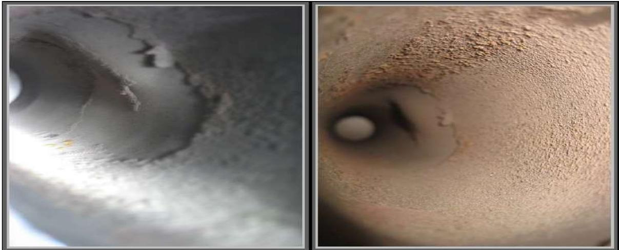
**Figura 21 Depósitos en tubos de alimentación de agua, Fuente: Informe técnico de inspección de caldera, Celulosa Arauco.**
