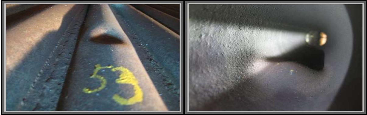
**Figura 20 Daño en la tubería #53, Fuente: Informe técnico de inspección de caldera, Celulosa Arauco.**
