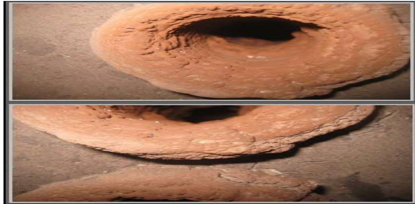
**Figura 24 tuberías obstruidas, Fuente: Informe técnico de inspección de caldera, Celulosa Arauco.**
