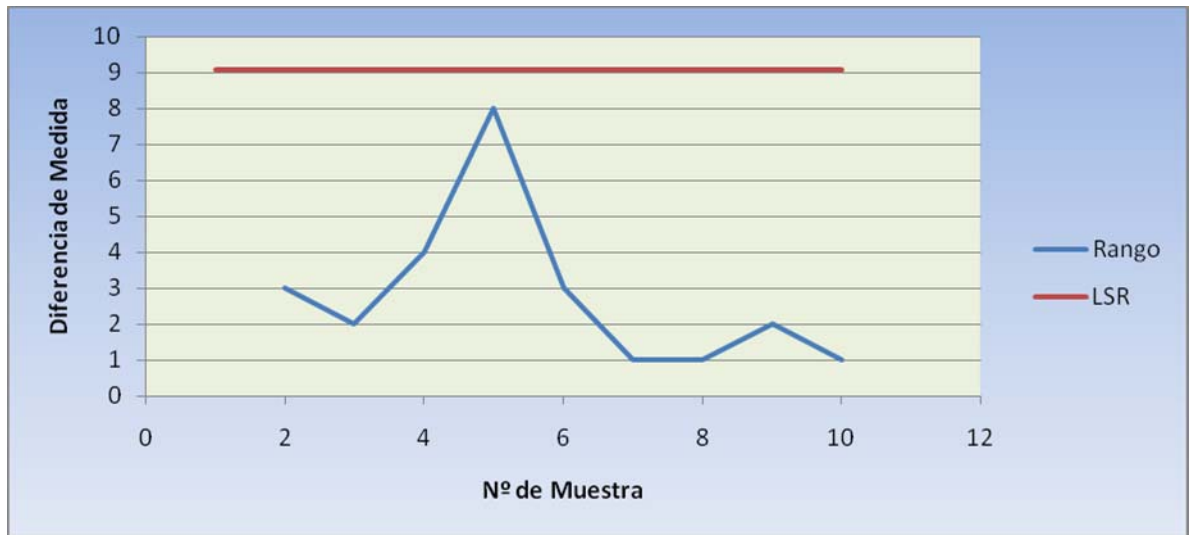
Fig. 2.6: Gráfico ejemplo de serie de rangos de mediciones de datos, aplicado a la metodología seis sigma.
