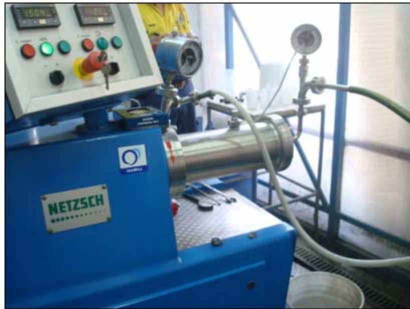
Figura 3-22. Molino IsaMill de Laboratorio
