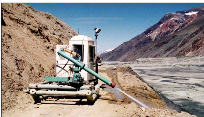
Figura 4-35. Máquina de Pitoneo y Cabina de Control
