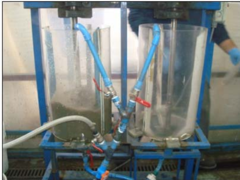
Figura 3-23. Sistema alimentación y recepción de producto molienda IsaMill
