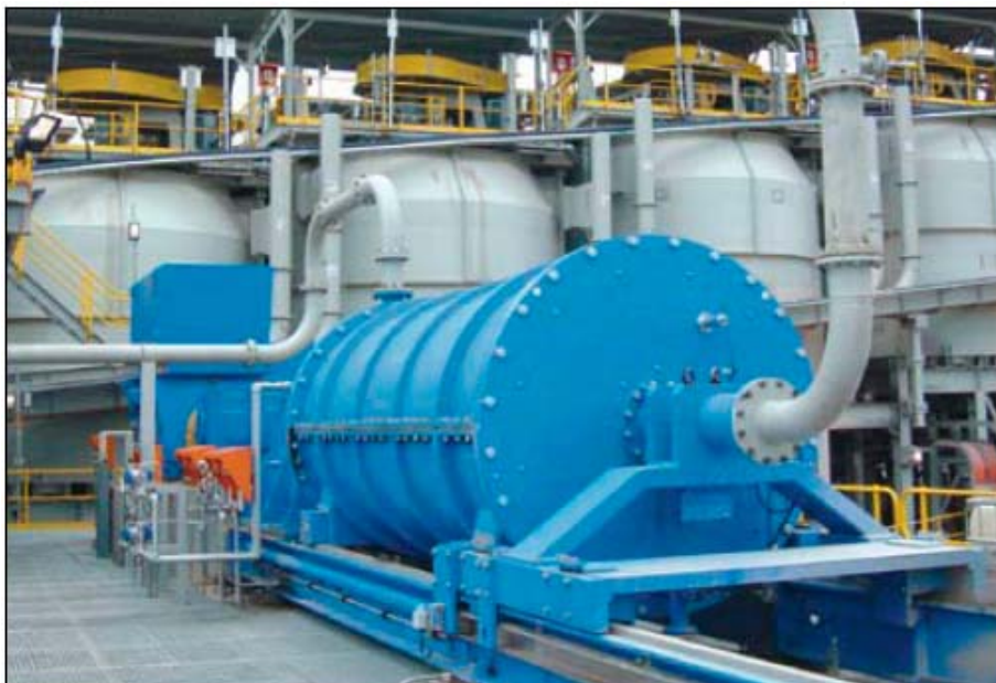
Figura 2-4. Molino de Remolienda Isamill
