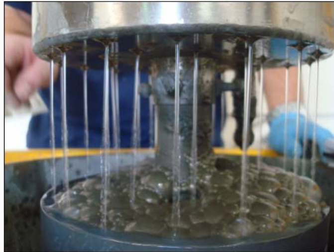
Figura 3-28. Sistema de lavado Celda Jameson
