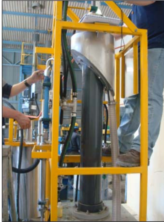
Figura 3-27. Celda Jameson de Laboratorio
