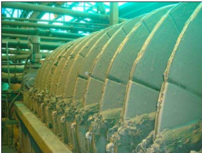
Figura 5-45. Filtro de disco cerámico Planta Convencional de Filtros PPC Codelco Andina
