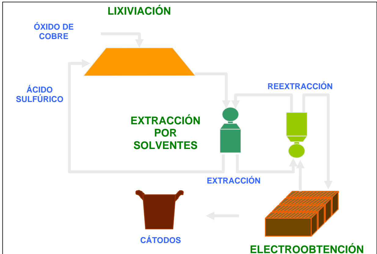
Figura 2.3. Proceso Hidrometalúrgico del cobre. 18
