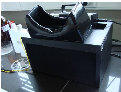
Figura 4.3. Aparato de visión ultravioleta utilizado para la lectura de las placas cromatográficas.
