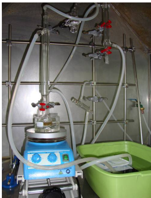
Figura 4.8. Sistema de reacción con reflujo de agua.
