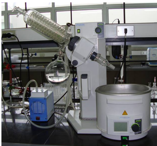
Figura 4.10. Rotavapor utilizado en cada paso después de la separación cromatográfica.
