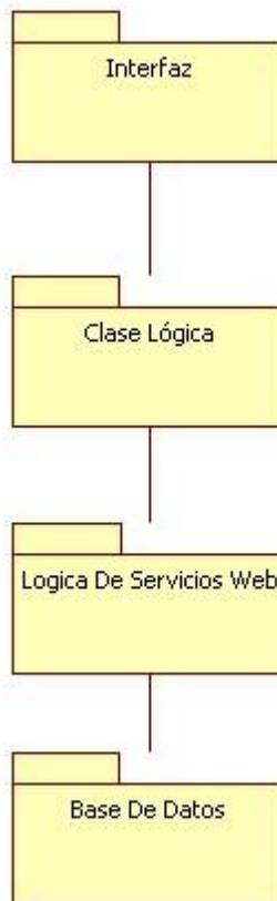
Figura 4.21: Diagrama de componentes del sistema
