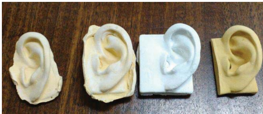
Figura 2-6: Réplicas de pinna del modelo original GRAS, yeso piedra y yeso ortopédico.
