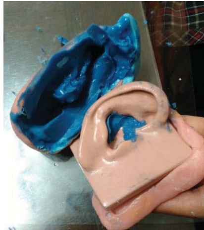
Figura 2-4: Resultado posterior a la utilización de la silicona en la oreja GRAS, se observa que se adhiere, por lo cual no cumple con lo requerido por pérdida de material.
