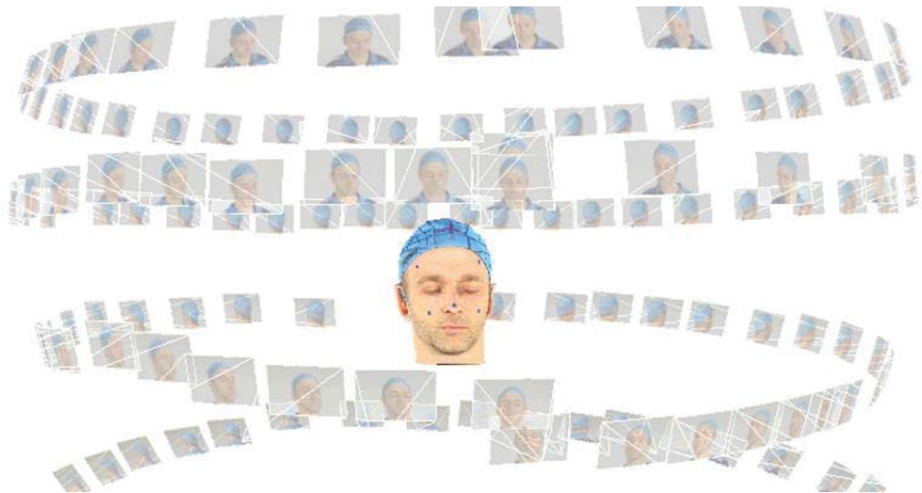
Figura 3-18: Modelo 3D CAD no híbrido. Imagen capturada desde software 3D Zephyr con proyección de disposición de orbitas de cámaras.
