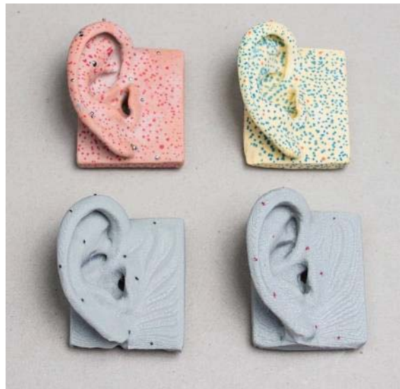
Figura 4-2: oreja GRAS, réplica de yeso, impresión desde la técnica fotogramétrica, impresión desde el escáner 3D.
