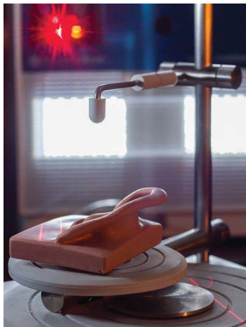
Figura 3-14: Proceso de adquisición de datos, por medio de los láseres del escáner NextEngine 3D.
