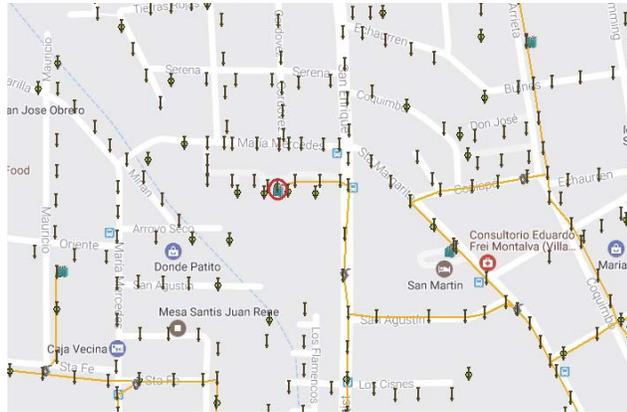
Figura 4-1: En un círculo rojo el transformador a estudio. En color amarillo la línea de media tensión [44].
