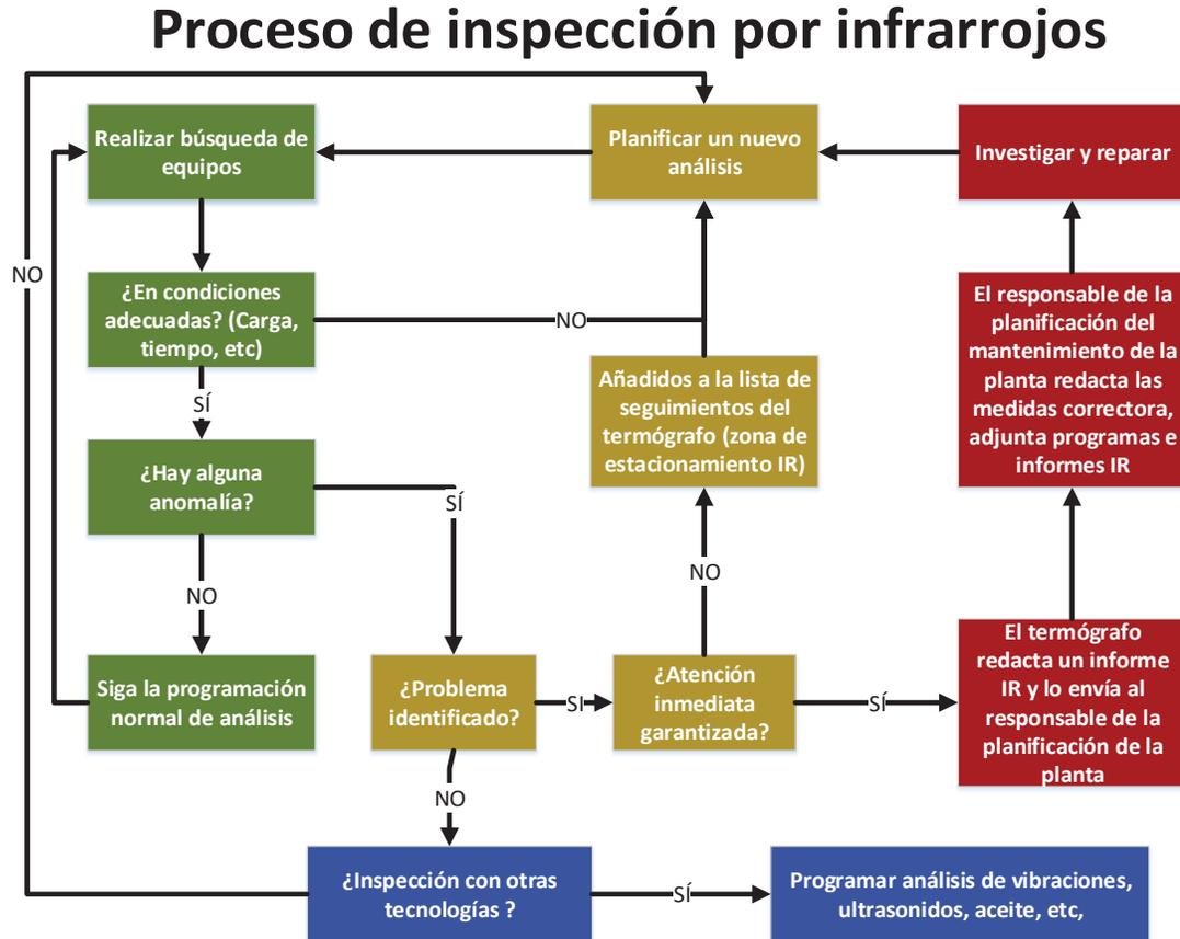
Figura 2-15: Este diagrama de flujo es un ejemplo de cómo la termografía puede encajar de forma lógica en un programa de mantenimiento general que incluye otras tecnologías de mantenimiento predictivo [41].
