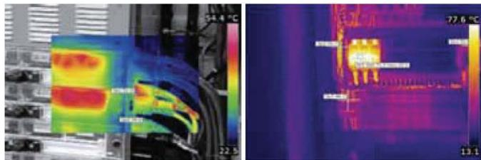
Figura 2-8: Conector recalentado debido a fusibles sobrecargados [38].
