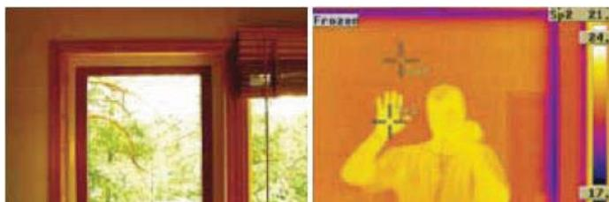
Figura 2-11: Efecto de la Reflexión en una ventana al hacer análisis térmico [38].
