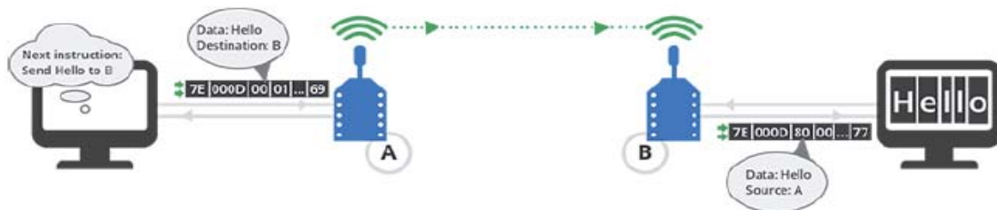
Figura 4-2: Ejemplo de transmisión en modo API (fuente: Xbee guía del usuario).
