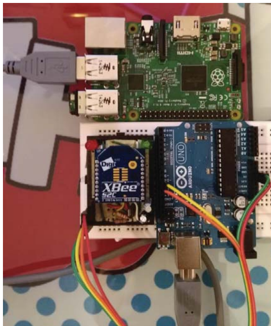
Figura 4.12: Conexión entre Xbee y Arduino (fuente: propia).
