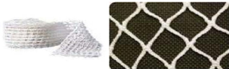
Figura 1. Mallas tipo Raschel cruda usadas por la industria.
