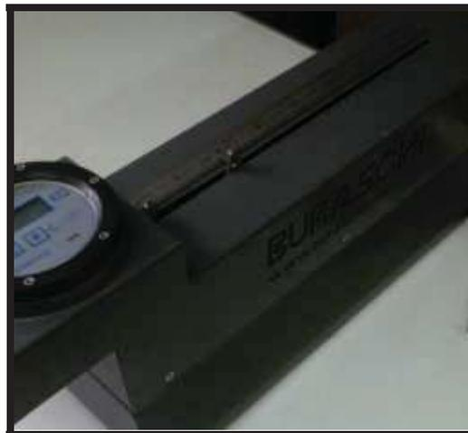
**Figura 4.** Dinamómetro Buraschi 400DP.
