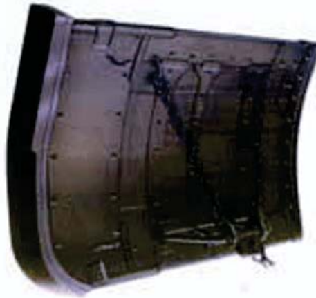
Figura 4. Portalón rectangular curvado. Fuente: Fisheries Research Service (2004).
