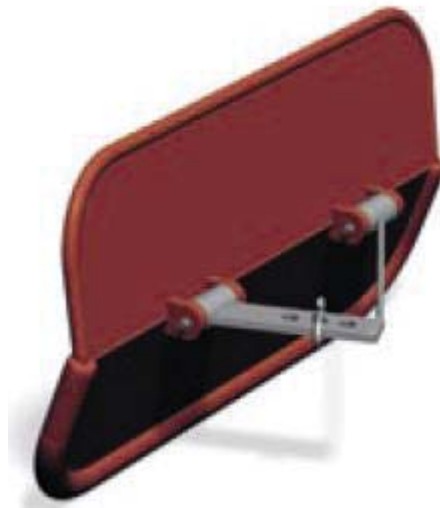
Figura 6. Portalón rectangular en V. Fuente: Fisheries Research Service (2004).
