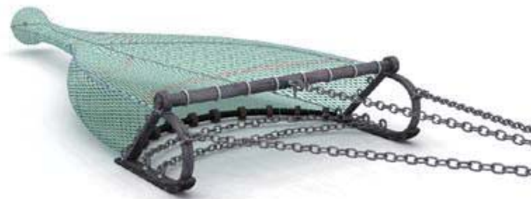
Figura 1. Arte de arrastre de boca fija. Fuente: Fisheries Research Service (2004).
