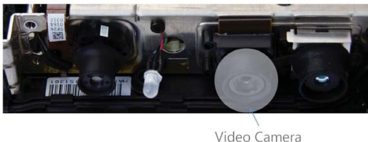
Figura 15: Vista cámara web de la kinect.
