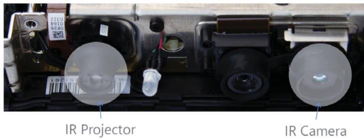
Figura 17: Vista de las cámaras infrarroja de la Kinect.
