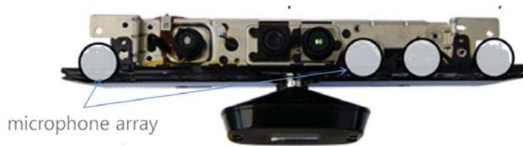
Figura 16: Vista de los micrófonos de la Kinect.
