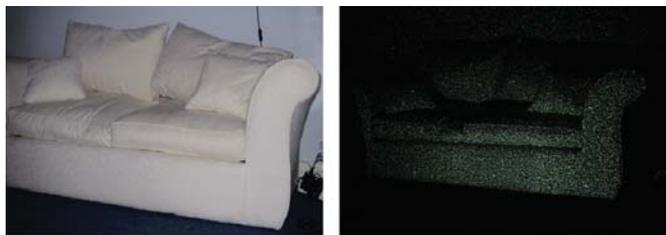
Figura 18: Ejemplo de cómo ve la kinect.
