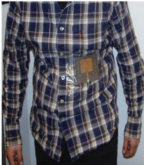
Figura 1-2 Antena de 2.5 GHz tipo parche microstrip [8].
