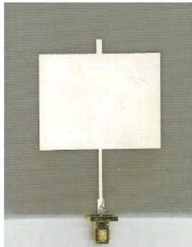
Figura 1-8 Antena fabricada con el método de “Screen Printed” [11].
