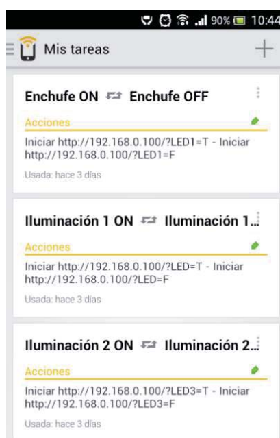
Fig. 6-13: Configuración final de la aplicación TRIGGER para el control de actuadores desde ARDUINO por sistema NFC.
