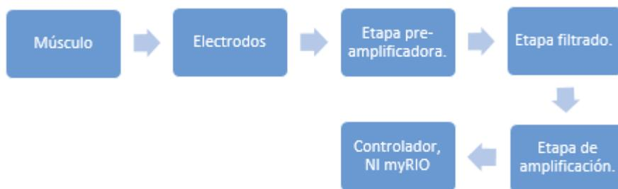
Figura 3-1: Diagrama de bloques para el sistema de adquisición EMG.
