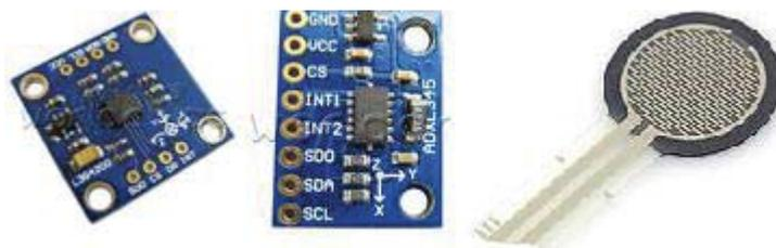
Figura 8-7: giroscopios y sensor de presión.
