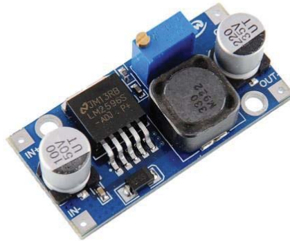
Figura 3-11: Regulador de Voltaje Step-Down (fuente: www.maxelectronica.cl )
