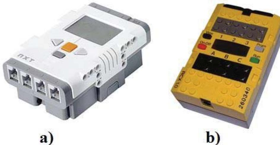
Figura 3.10 Bloques Programables. (a) Bloque programable NXT, (b) Bloque programable RCX.
