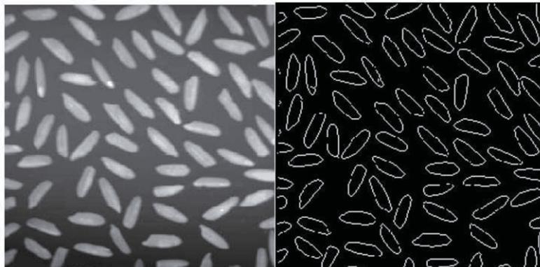
Figura 3.36 Resultado de la detección de bordes mediante el operador de Canny.
