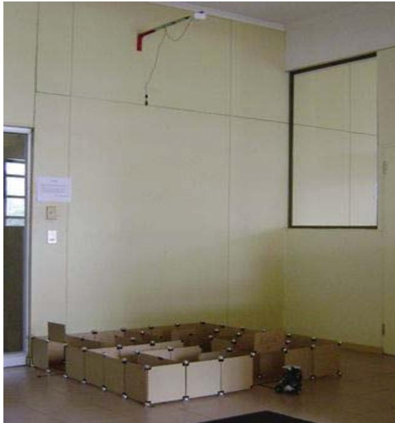
Figura 4.17 Entorno completo: Robot, laberinto, brazo y cámara.
