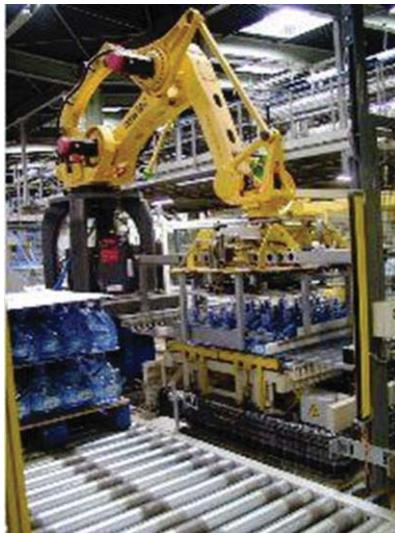
Figura 3.6 Robot poliarticulado de palatización de cargas unitarias.
