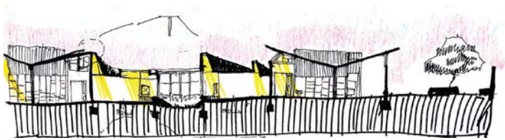
Corte esquemático del total del proyecto Sala de actividades / corredor / patio central Se piensan diferentes tipos de luz para estos tres espacios y diferentes tipos de cielos.
