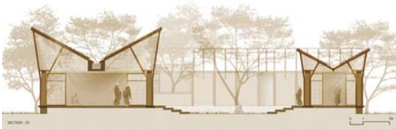
Corte arquitectónico. A observar: 1. Sistema estructural de las cubiertas. El agua confluye a una viga central que actúa de canaleta, de gran dimensión. Esta condición estructural es pensada para adar un aire entre muros y cielo. Veneficia la ventilación cruzada y el contacto visual con los árboles del exterior. 2. Patio central como vinculador entre los edificios construidos.
