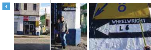
Señalética: Wheelwright (Calle Wheelwright con Cochrane) Dimensiones: 29 cms x 78 cms. Distancia respecto al suelo: 1.81 mts Materialidad: Pintura negra para el fondo y blanca para el texto. Soporte: pintada sobre el muro Legibilidad: Media Observaciones generales: La señal esta rayada. Su tamaño esta forzado para que calce con en el muro.
