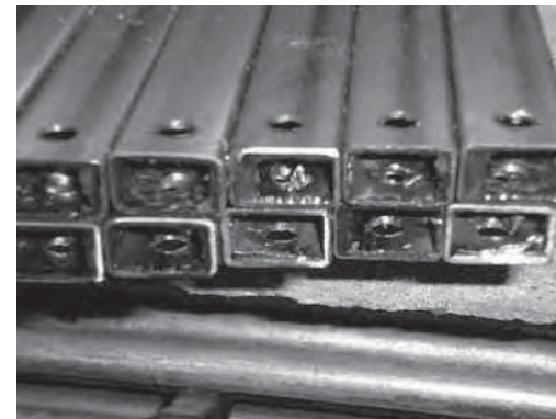
FIERROS PERFORADOS EN UN EXTREMO CON REBABA REMOVIDA
