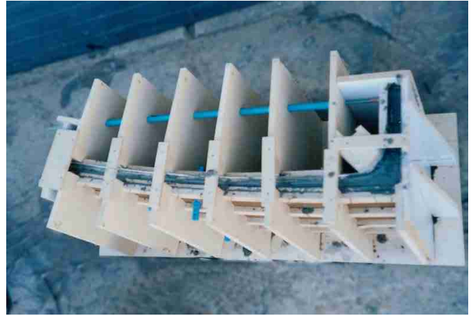
vista matriz, llena con el cemento vaciado
