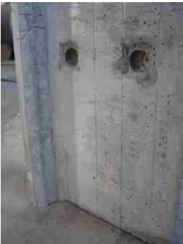
terminación de las perforaciones en una 2ª y 3ª prueba
