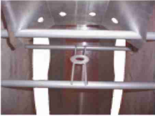
colocación del sistema de quemador en la mesa
