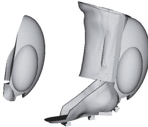
Figura 5-18. Soporte Físico de la utilidad. Izquierda soporte electrónico, derecha órtesis completa.
