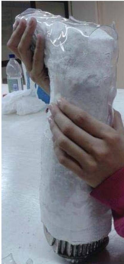
Figura 1-12 Termoformado de la órtesis.(fuente: <http://disenobiomecanico.blogspot.cl>)
