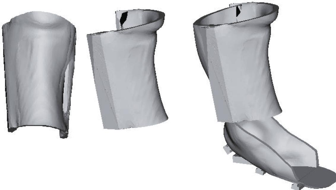
Figura 5-8. Pieza diseñada para desplazar carga hacia la rodilla. Izquierda pieza, derecha uso en la órtesis.
