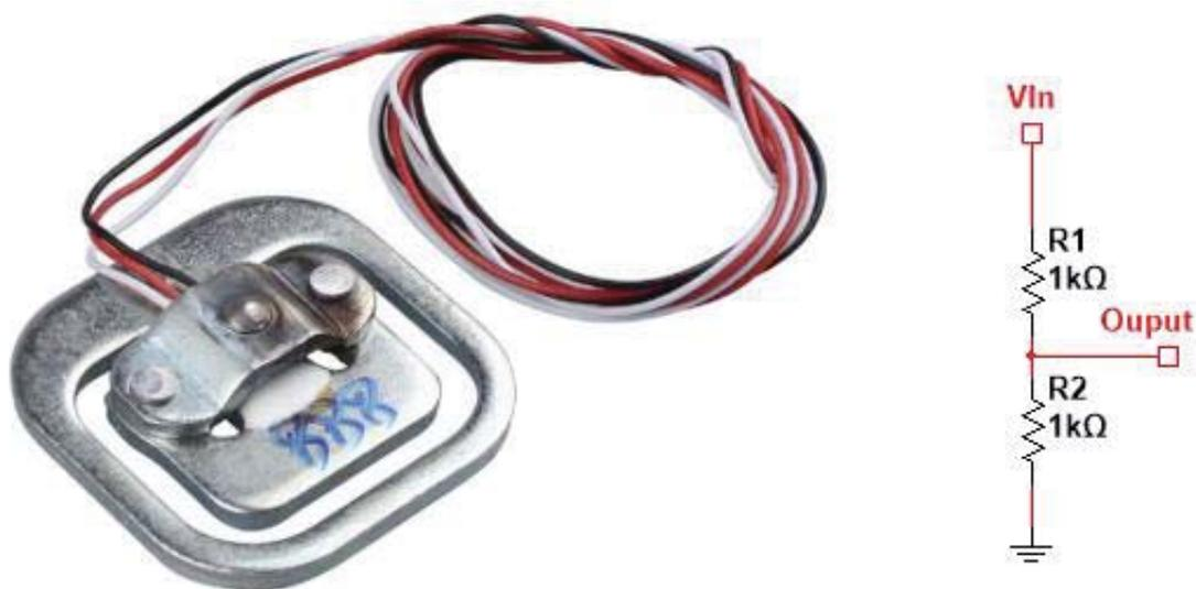
Figura 5-9. Sensor de Carga de 50[Kg]. Izquierda sensor, derecha esquemático.
