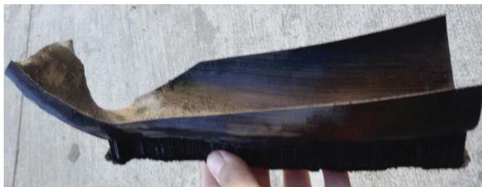
Figura 4-12: órtesis real de ejemplo, impresa en 3D.
