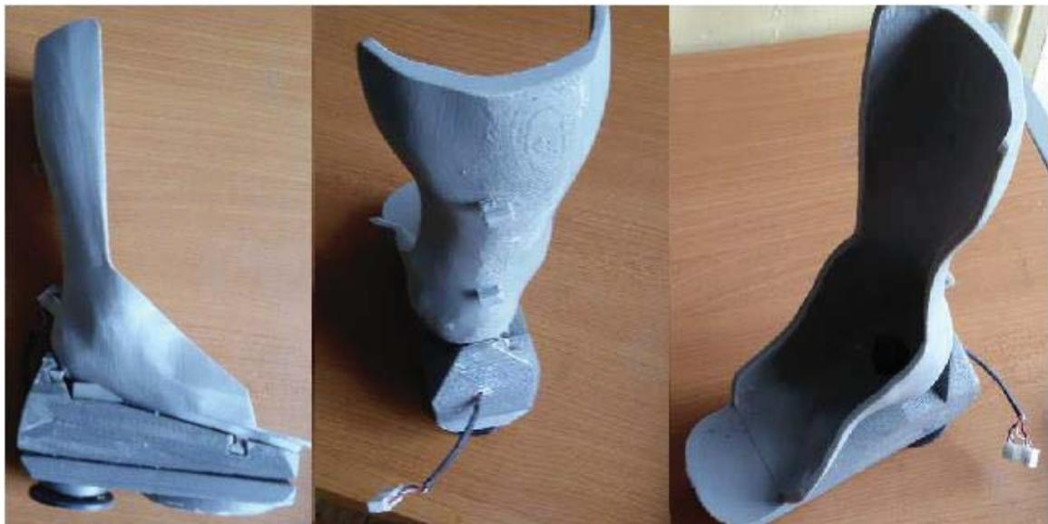
Figura 5-19. Base órtesis impresa. Izquierda vista lateral, centro posterior, derecha ángulo superior.
