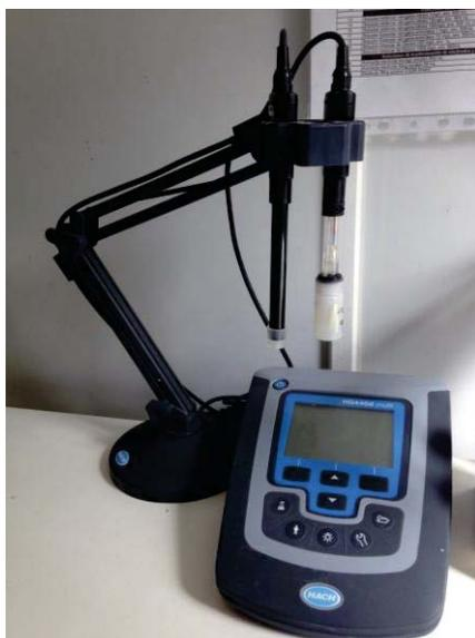
Figura 10: Multiparamétrico HQ440d multi.
