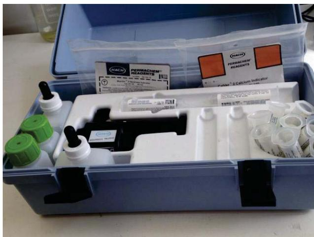
Figura 11: KIT HACH dureza total y calcio.
