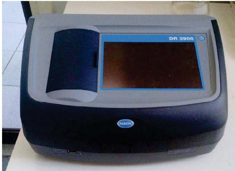
Figura 8: Fotómetro multiparamétrico HACH DR 3900.
