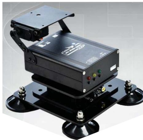
Figura 1-11: Antena de Seguimiento Automático Arkbird [8].
