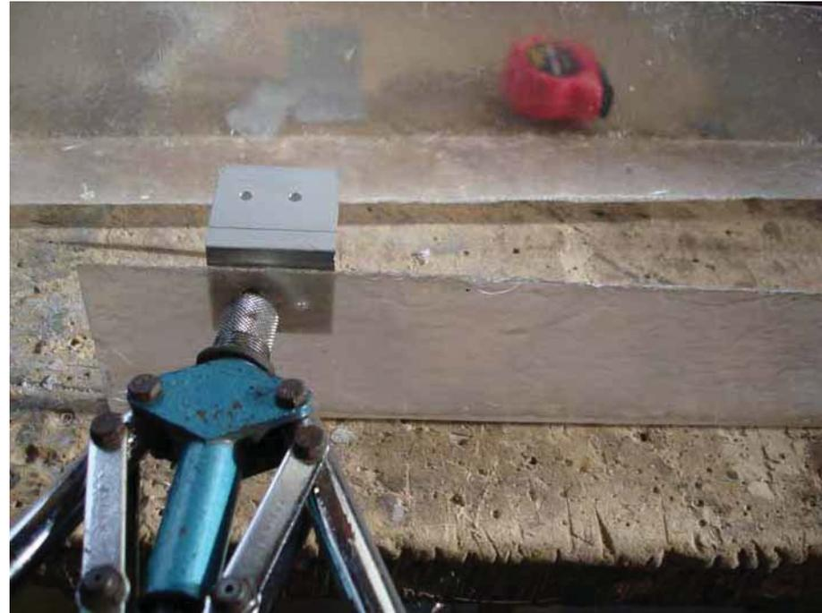
Con las pletinas terminadas, se realizaron las uniones de las piezas, teniendo en cuenta la misma distancia para cada una. La unión entre una pieza y otra, a través de pletinas, se hizo con remaches, del mismo diámetro de la broca, 4mm.
