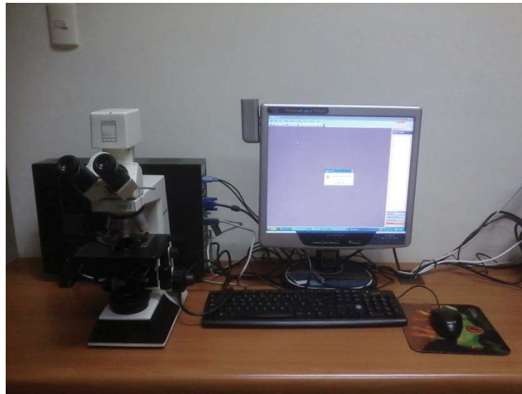
Figura 9. Microscopio óptico conectado al analizador de imágenes DIGIPRO 2.
