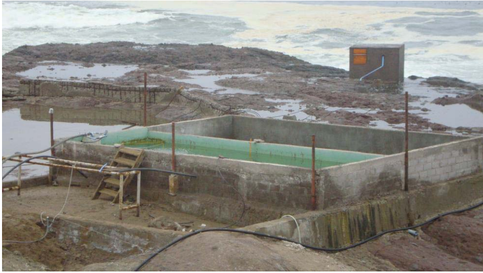
Figura 7. Ilustración del estanque de cultivo en mesocosmo para larvas de Engraulis ringenes .
