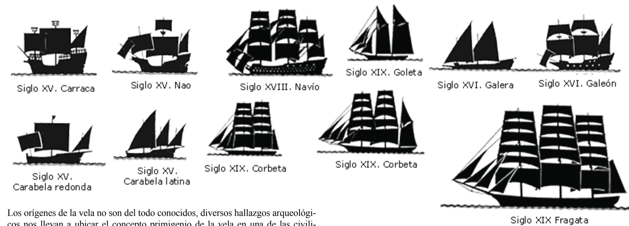
Figura 35. Esquema de la evolución de los velámenes de las embarcaciones a lo largo de la historia / Imagen: http://axanel.files.wordpress.com
