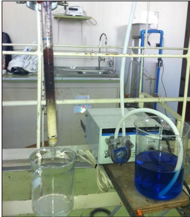
Figura N 24: Columna Intercambio Iónico.
