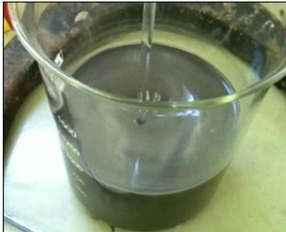
Figura N 14: Lixiviación Directa en medio ácido
