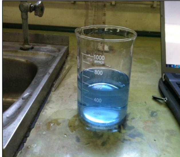
Figura N 12: Solución PLS obtenida de la lixiviación con  $\text{NH}_4\text{OH}$
