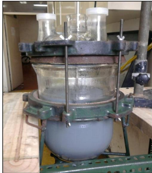
Figura N 9: Reactor de Lixiviacion
