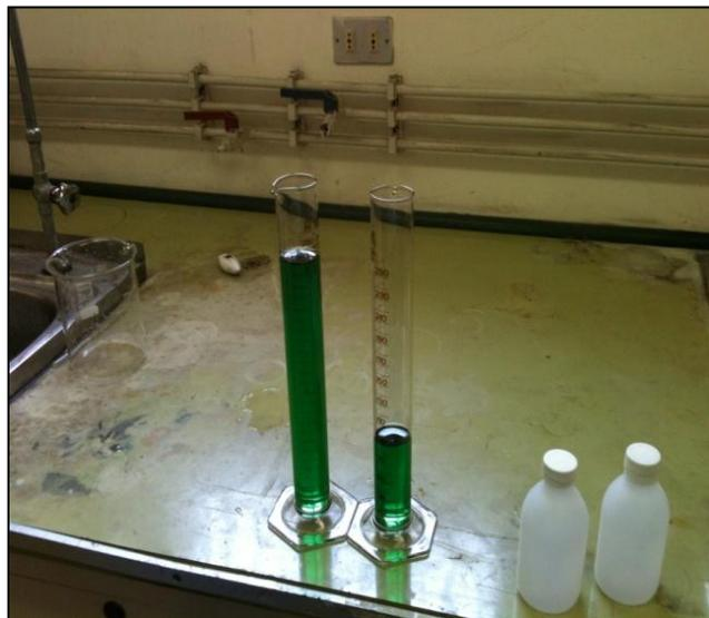
Figura N 13: Solución PLS obtenida de la lixiviación con  $\text{NaOH}$ .
