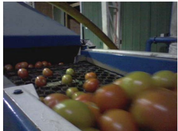
En la cosecha tradicional en naves de tomates, una máquina se encarga de pre-seleccionar por tamaño, luego viene el trabajo manual de separar los tomates de primera y segunda.
