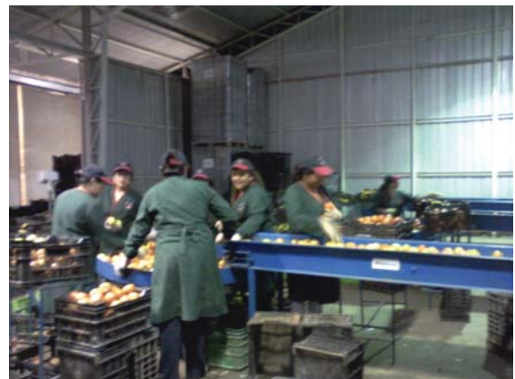
En la cosecha tradicional en naves de tomates, una máquina se encarga de pre-seleccionar por tamaño, luego viene el trabajo manual de separar los tomates de primera y segunda.
