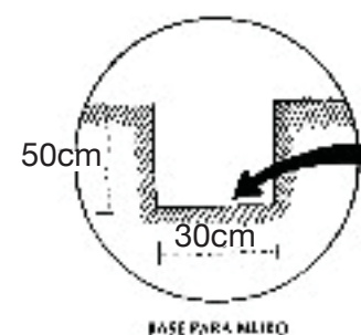
IMG.74 pie derechos y su instalación
