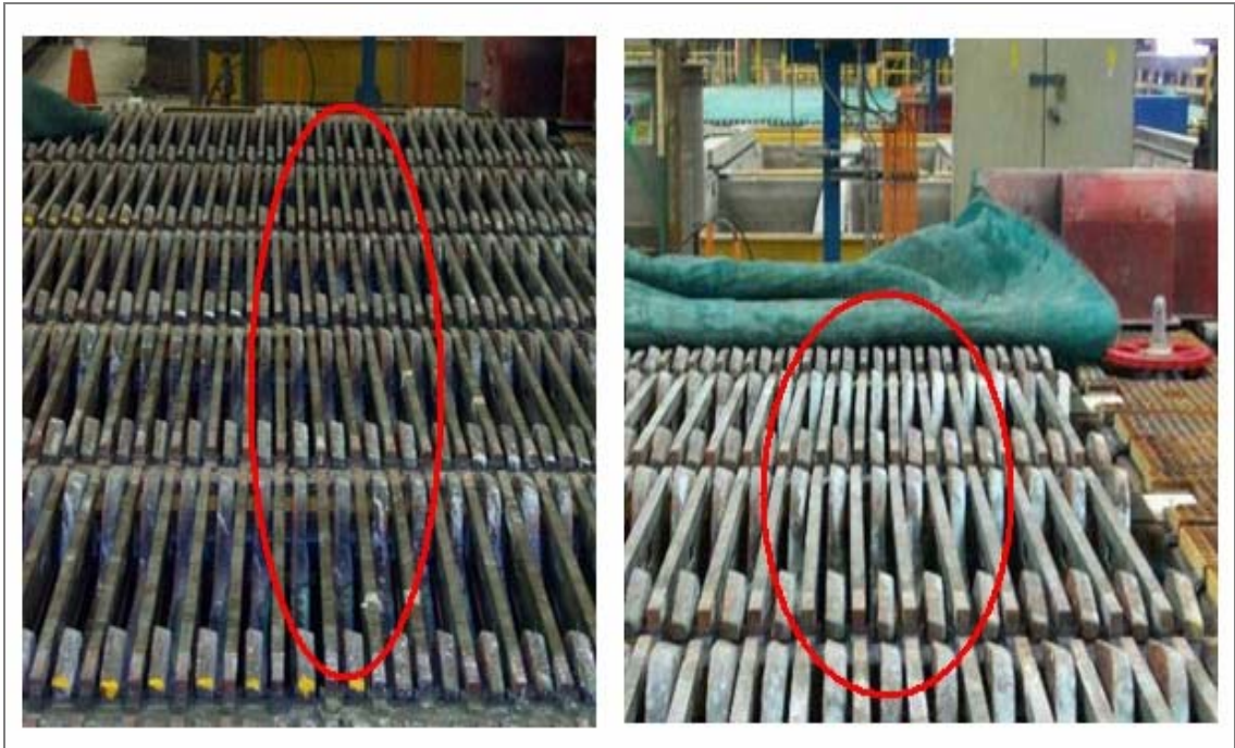
Figura 4- 19: Ejemplo de voltajes de contacto de cátodos en operación en celdas de refinación con capping board de goma en semisección 14-1B.
