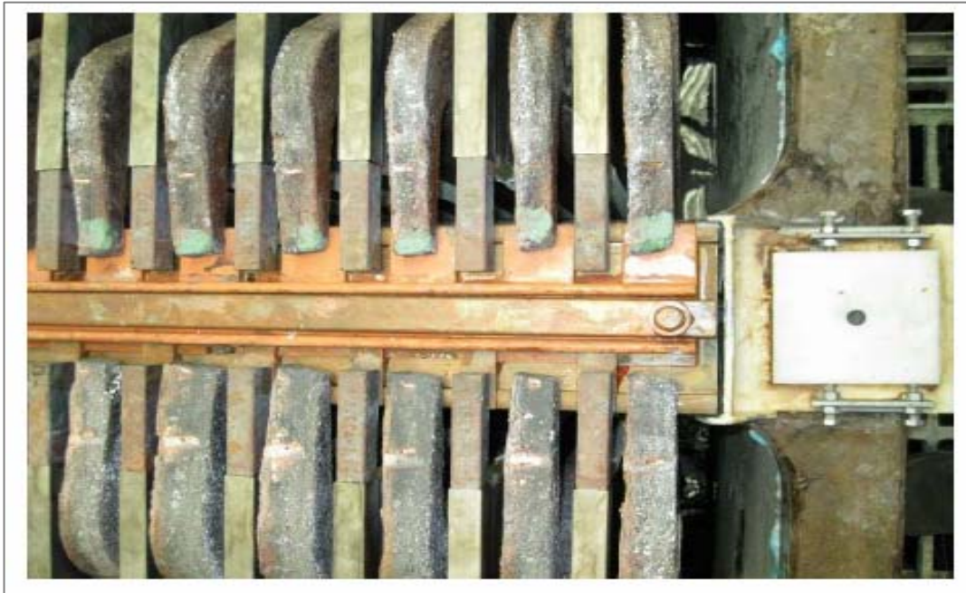
Figura 4- 3: Vista superior de barra Multicircuital diseño Optibar 1.0 con capping board de compuesto polimérico cargada con ánodos y cátodos durante la etapa de prueba.
