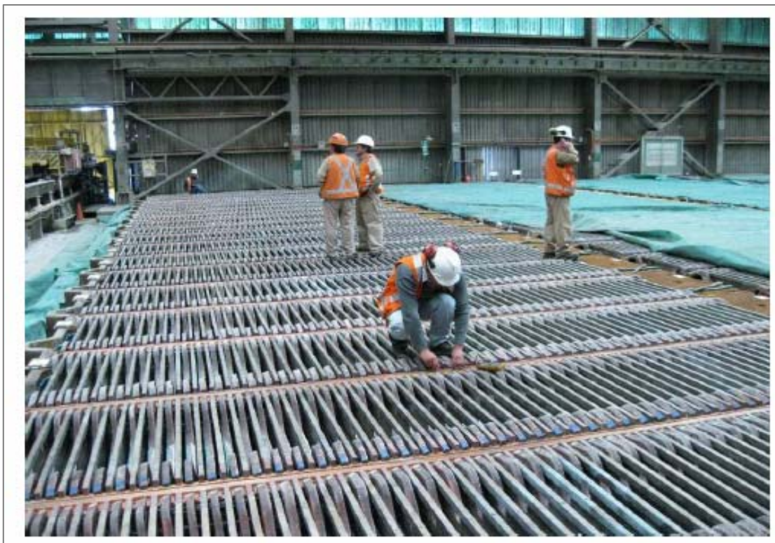
Figura 4- 4: Vista de semisección 14-1A con barras intercelda Multicircuitales diseño Optibar 1.0 en operación en Refinería N° 2, Codelco Norte.
