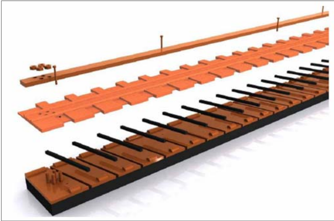
Figura 4- 1: Despiece de la barra intercelda Multicircuitual diseño Optibar 1.0 para implementar la tecnología Multicircuitual en Refinería N° 2, Codelco Norte.
