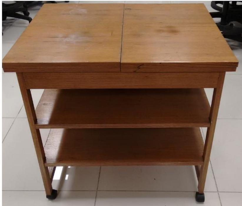
Figura 3-25: Base móvil utilizada para la adquisición y desplazamiento del radar, cuando se necesita de una apertura sintética mayor.
