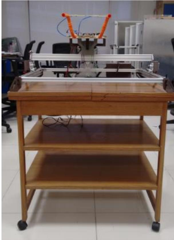
Figura 3-26: Radar montado y asegurado en conjunto con el riel sobre la base móvil.
