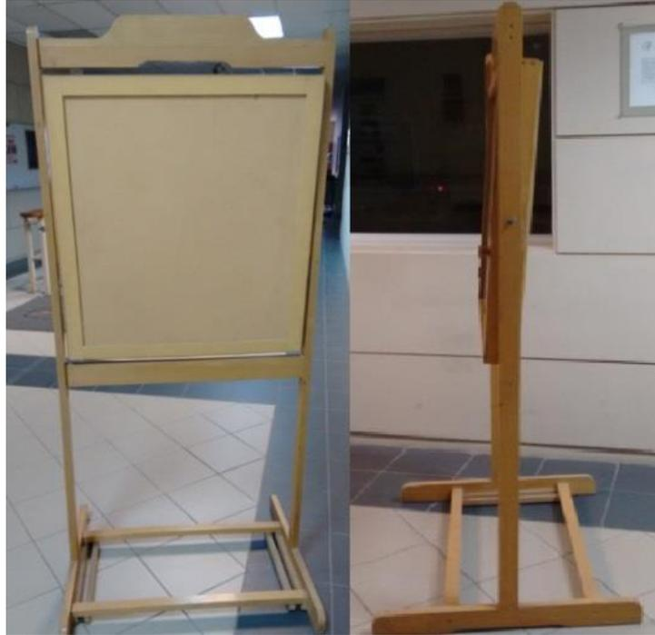
Figura 3-35: Panel de madera que se encuentra en el 3 piso de la EIE-PUCV, las dimensiones del panel son, alto: 1,8 [m], largo del panel: 85 [cm], ancho del panel: 75 [cm], grosor del panel: 10 [cm].
