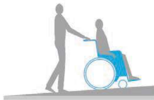
Con ayuda y esfuerzo, pendiente mayor a 12%
