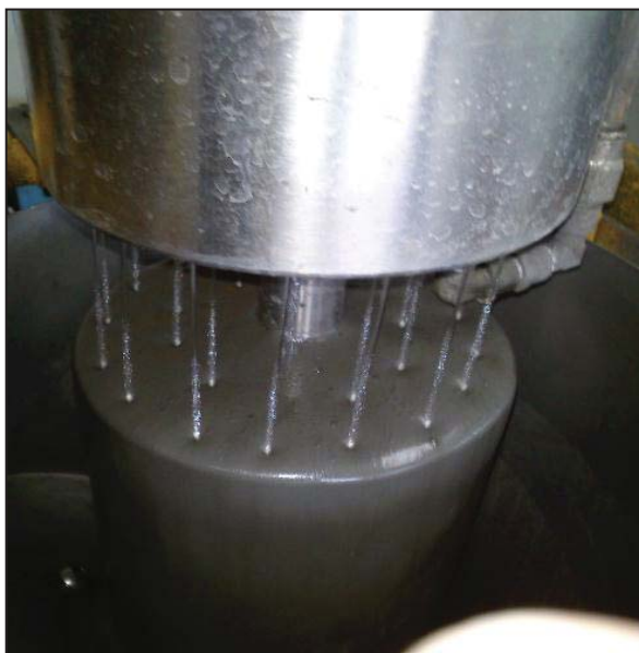
Figura 4-7. Sistema de lavado celda Jameson
