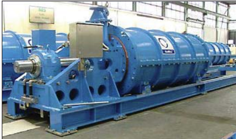
Figura 2-8. Molino de remolienda IsaMill™.
