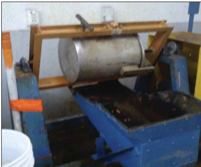
Figura 4-3. Molino bulk instalaciones SGS Pudahuel
