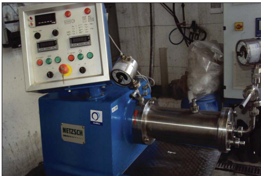
Figura 4-5. Molino IsaMill™ instalaciones SGS Quilicura
