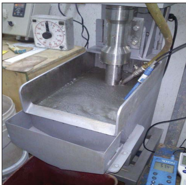
Figura 4-4. Celda de flotación bulk instalaciones SGS Pudahuel
