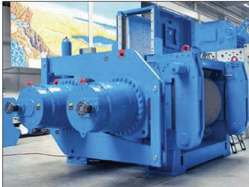
Figura 2-4. Chancador de Rodillos Abrasivos de Alta Presión HPGR
