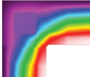
Figura 41. Muestra infrarroja de la unión de pilares con ambos muros. Fuente: Elaboración Propia.
