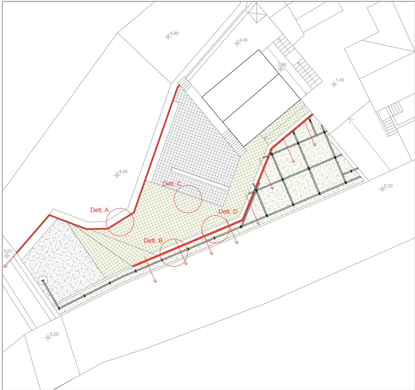
Pianta, scala 1:250. Pianta pavimenti e scorrimento delle acque piovane.
