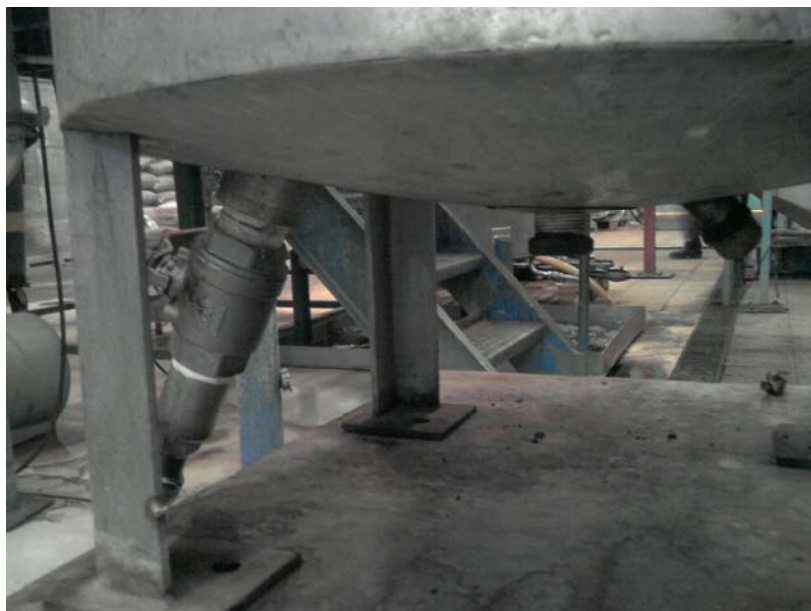
Figura 17: Vista del cabezal inferior del equipo (enchaquetado). Se muestran además los soportes y la vía de descarga del fluido a extraer.
