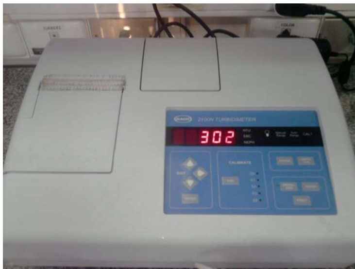
Figura 3: Instrumento para medir la turbidez (NTU del extracto).
