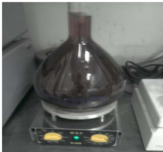
Figura 2: Proceso de Calentamiento de la mezcla de Té con agua caliente por 2 horas.
