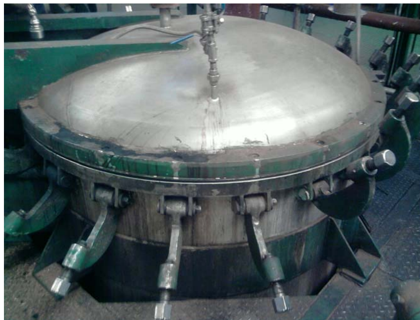
Figura 37: Tapa superior en el diseño del equipo a cotizar.
