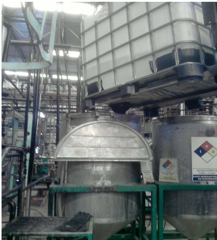
Figura 28: Descarga de H_2O_2 a estanque para su uso en proceso de reacción.
