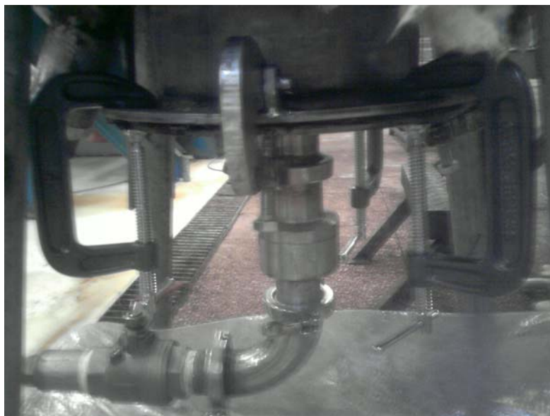
Figura 19: Cabezal inferior y salida del extracto obtenido, una vez modificado.
