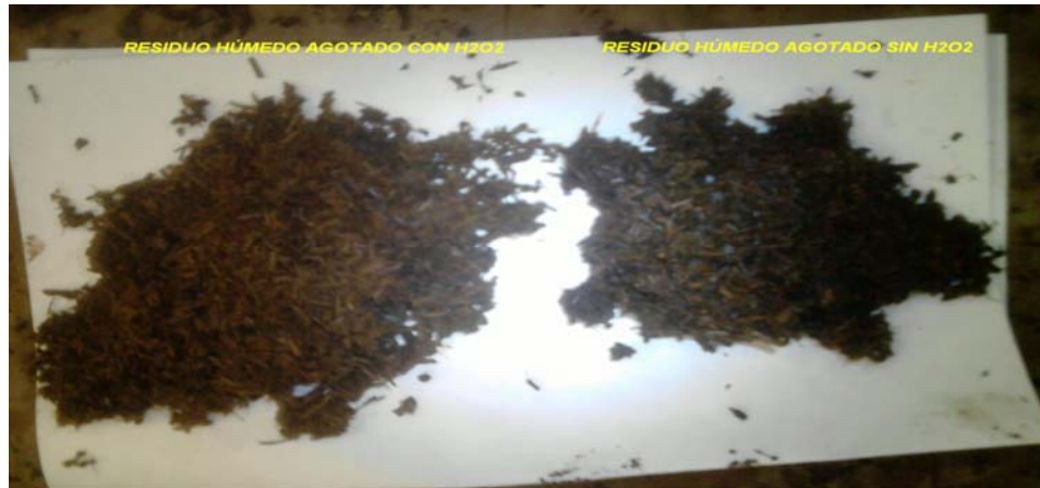
Figura 1: Comparación residuo agotado con Peróxido y con agua normal.
