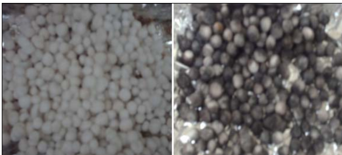
Figura 15. Catalizadores: izquierda con MgO y derecha con CuO.
