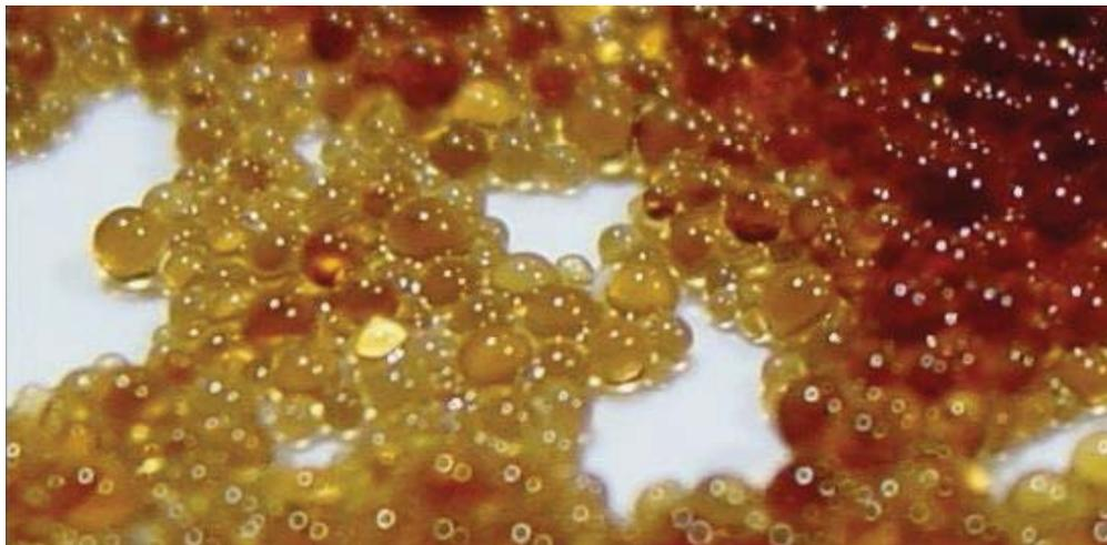
Figura 3.8: Resina de intercambio iónico Amberlite.
