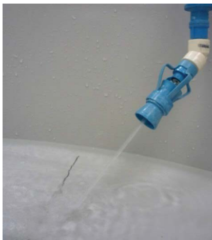
Figura 12: Eductor en posición 45°-45°
